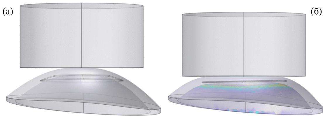
Рис. 4. Модель аппланации роговицы жестким штампом (аппланационной линзой): а — начальное положение; б — конечное положение штампа
